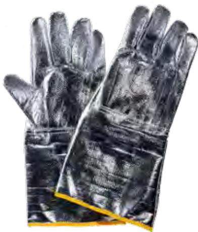
Guanto per fonderia e metallurgia. Struttura in fibra aramidica alluminizzata, interno foderato in felpa di cotone. Protezione termica (calore radiante, convettivo, spruzzi di metallo fuso). Robusto e resistente.
