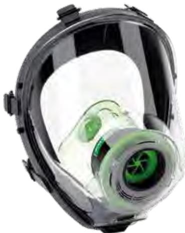
Taglia universale, bardatura regolabile a sgancio rapido a sei punti di attacco e guarnizione esterna in gomma sintetica. Schermo panoramico, oronasale dotato di due valvole di inspirazione per evitare appannamenti.
