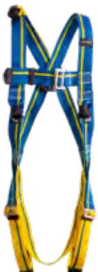
Imbracatura con ancoraggio dorsale con fascia di estensione in poliestere, ancoraggio sternale tessile, fibbie di regolazione su petto e cosciali, protezione in plastica sulle estremità delle fasce, componenti in acciaio con resistenza al test in nebbia salina di 120 ore, rispetto alle 72 ore richieste dalla norma. Peso 750 g.
