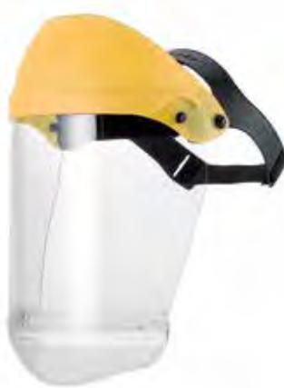
Fascia frontale in spugna tergisudore intercambiabile, banda superiore per la regolazione dell'altezza della calotta, regolazione di circonferenza cranica tramite fascia elastica, schermo in policarbonato spessore 1 mm ribaltabile di 90°, può essere indossata sopra ad occhiali protettivi e respiratori, mentoniera in policarbonato sostituibile, certificato al punto 3 della EN 166 per protezione da schizzi di liquidi, resistente ad impatti.
