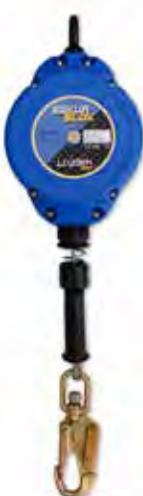
Robusto coperchio sintetico ad alta resistenza per offrire maggiore durabilità, sicuro per carichi massimi di 140 kg, riduce la forza di impatto al di sotto dei 6kN, anello girevole per evitare impigliamenti e migliorare il funzionamento del dispositivo. Indicatore di caduta: in caso di caduta la linea verde diventa rossa, indicando la caduta dell'utilizzatore. Cavo in acciaio zincato (4,5 mm).
