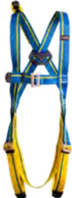
Imbracatura con ancoraggio dorsale per anticaduta, fascia di estensione in poliestere, fibbie di regolazione su petto e cosciali, protezione in plastica sulle estremità delle fasce componenti in acciaio con resistenza al test in nebbia salina di 120 ore, rispetto alle 72 ore richieste dalla norma. Peso 670 g.
