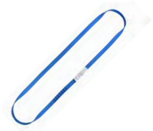
Fettuccia di ancoraggio realizzata in poliestere. Leggera e versatile è fra gli ancoraggi più utilizzati - Lunghezza 90 cm, peso 110 g, Resistenza 22 kN.
