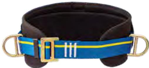
Cintura di posizionamento con anelli D laterali e anelli portastrumenti, imbottitura nella fascia lombare per un maggiore comfort, componenti in acciaio con resistenza al test in nebbia salina di 120 ore, rispetto alle 72 ore richieste dalla norma. Peso 580 g.
