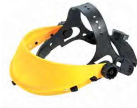
Semicalotta ergonomica in materiale anallergico, fascia frontale antisudore in spugna intercambiabile, banda superiore per la regolazione dell'altezza della calotta, regolazione circonferenza cranica tramite cremagliera (da 53 a 61 cm), ribaltabile di 90° tramite frizioni, 5 punti di aggancio per lo schermo, certificato con i simboli per il campo di utilizzo 3 della EN 166 per protezione da schizzi liquidi, resistente ad impatti e a temperature estreme.
