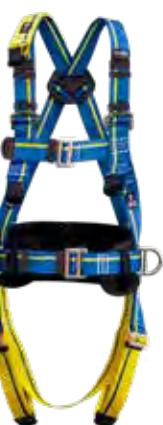
Imbracatura con ancoraggio dorsale con fascia di estensione in poliestere, ancoraggio sternale tessile, cintura di posizionamento con anelli D laterali e anelli portastrumenti, imbottitura nella fascia lombare per un maggiore comfort, fibbie di regolazione su petto, cintura e cosciali, protezione in plastica sulle estremità delle fasce, componenti in acciaio con resistenza al test in nebbia salina di 120 ore, rispetto alle 72 ore richieste dalla norma. Peso 1,2 kg.
