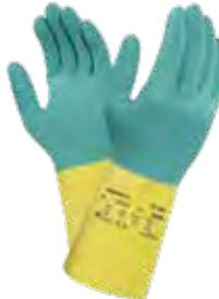
Guanto in lattice naturale con mescola di Neoprene per maneggio di sostanze chimiche, spessore 0,68 mm, interno felpato in puro cotone, trattamento "Sanitized Actifresh", finitura esterna in rilievo a rombi, con ottima presa asciutta e bagnata, doppia protezione, lunghezza 323 mm.
