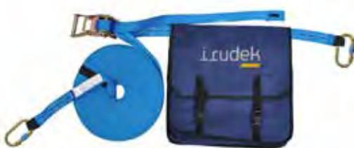
La linea vita è certificata per essere utilizzata da 2 persone contemporaneamente, lunghezza regolabile da 5 a 20 metri, dotata di tenditore per tendere facilmente la fettuccia di poliestere, include 1 moschettone ad ogni estremità della fettuccia per collegare la linea di vita ai punti di ancoraggio. Racchiusa in una pratica borsa.
